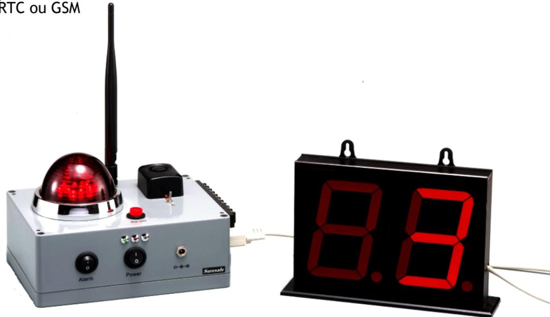
Système de réception complet avec sirène, flash et afficheur pour distinguer le PTI en alarme
